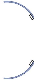
2. Colocar los E-TACO3 en la cara interior del conducto en los lugares en los que debe ir el minipestilillo.
