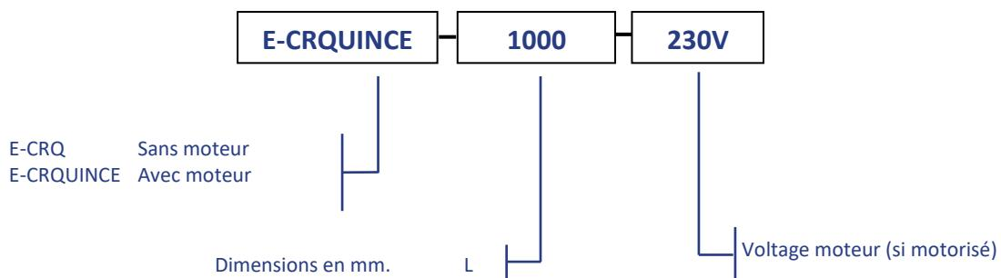
EXEMPLE: E-CRQUINCE 1000 x300 230V: Clapet E-CRQ avec moteur en 230 V de longueur 1000 mm.
