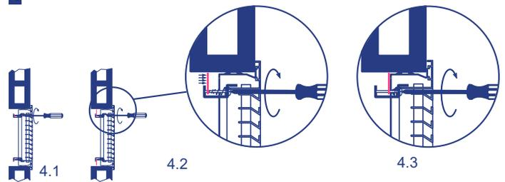
4.1 À l'aide d'un tournevis, vissez la languette pour la placer horizontalement.
