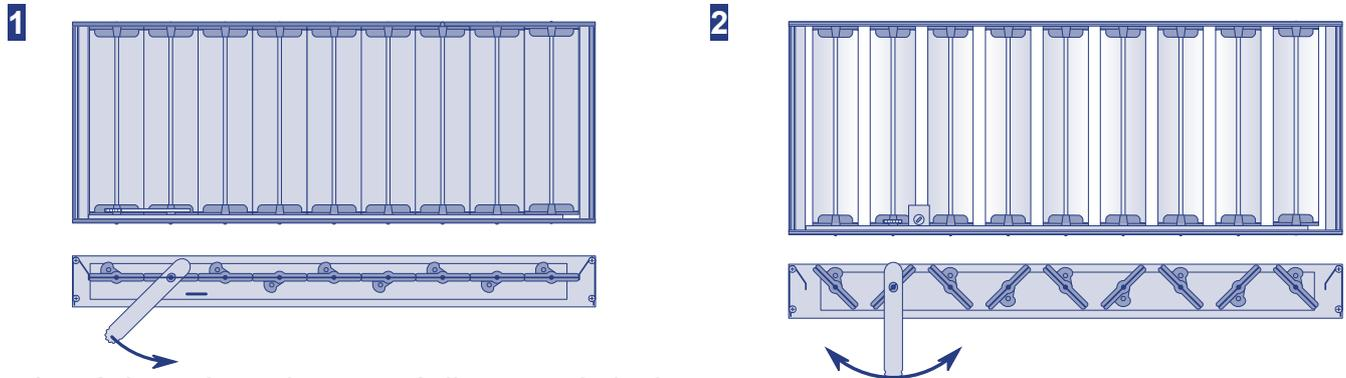
1. Le réglage du registre se réalise avec le levier qui dépasse légèrement de la partie frontale de la grille.
