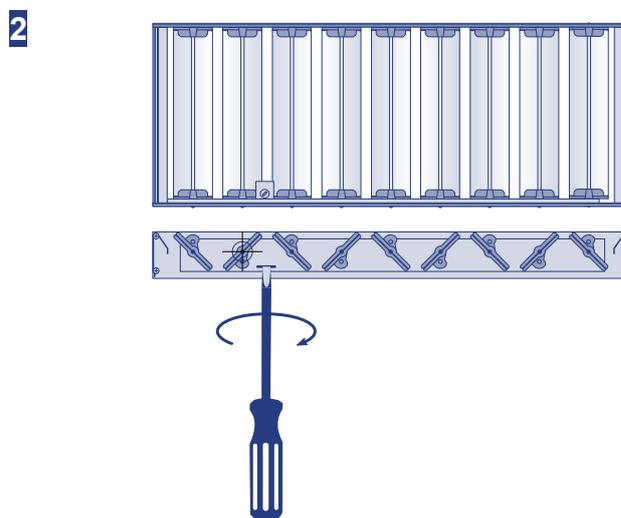
1. Tournez le vis avec un dévissage jusqu'à obtenir l'ouverture souhaitée.
