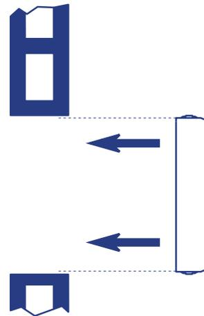
2. Installez le contre cadre (E-MM o E-MAM). Fixez-le au mur avec dur mortier ou du plâtre.
