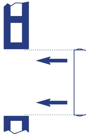
2. Installez le contre cadre (E-MM o E-MAM). Fixez-la au mur avec dur mortier ou du plâtre.
