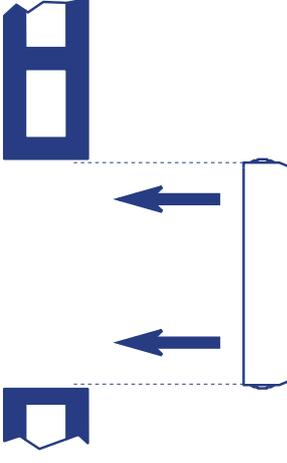
2. Installer le contre cadre (E-MM o E-MAM). Fixez-le au mur avec du mortier ou du plâtre.
