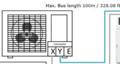
**NOTA:** El bus XYE consta de 3 hilos (XYE). Sólo deben conectarse al equipo los hilos XY, como se indica en el esquema.
