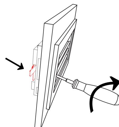
6 – Seguir girando el tornillo a la derecha hasta que la lengüeta haga tope con el marco de montaje.
