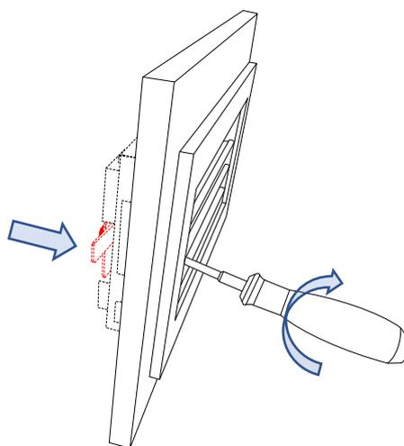
6 – Seguir girando el tornillo a la derecha hasta que la lengüeta haga tope con el marco de montaje.
