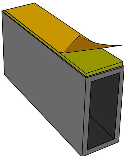
2' – Desenganchar la cara adhesiva del taco.
